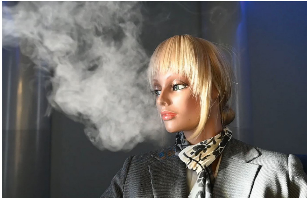
Abbildung 1: Aerosolausstoß beim Atemvorgang einer Person simuliert in einem Prüfstand
